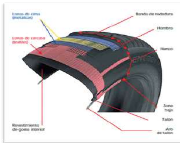
Fig.1.2. Partes de una llanta de automóvil.
